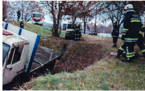
Bergung mittels Seilwinde und Umlenkrolle
