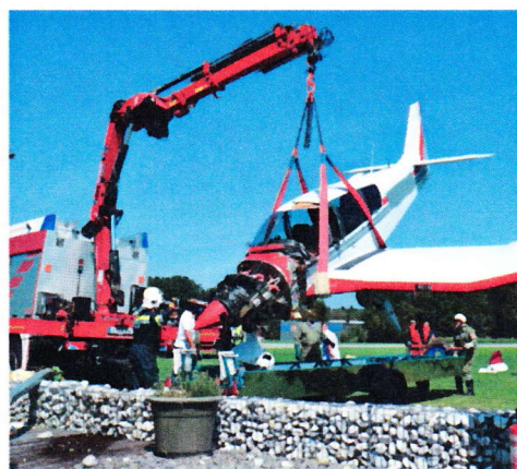
Bergung eines verunfallten Flugzeuges mit dem Teleskopkran
